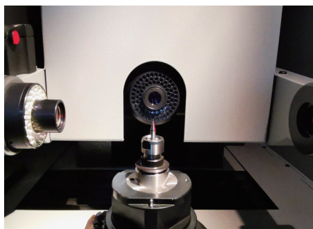
图 10 Zoller 对刀检测过程 ( \phi 0.5\text{mm} 铣刀)
